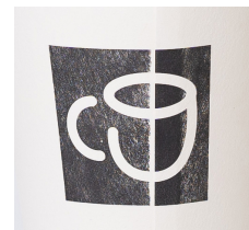
③ 貼り合わせの印刷抜け
